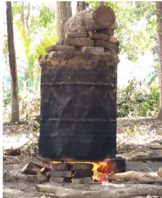
Gambar 1. Pembakaran Jerami Padi dengan Metode Pirolisis
