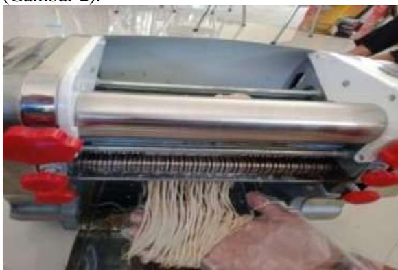
Gambar 2. Pembuatan mie basah dengan mesin pembuat mie
