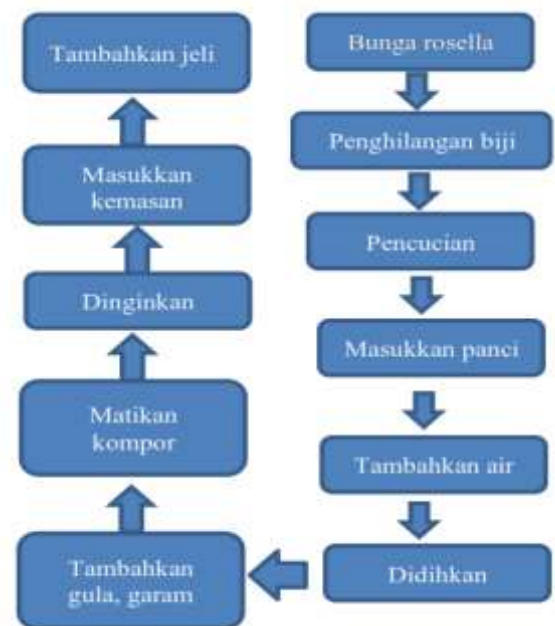
Gambar 4. Diagram pengolahan produk minuman jeli
