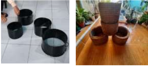
Gambar 4. Cetakan/mal pot (kiri) dan pot sabut kelapa (kanan)
