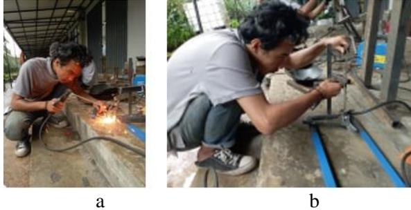
Gambar 5. *Assembly* berupa (a) pengelasan, dan (b) pemasangan mur baut
