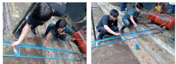
Gambar 7. Proses pengecatan pada komponen tempat menaruh pot tanaman
